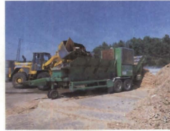
Altholz wird zur Wiederverwertung geschreddert
