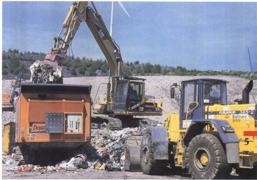
Schredderanlage zur Vorzerkleinerung des Hausmülls
